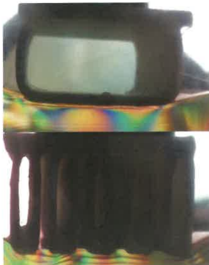
Figura 3. Pruebas por fotoelasticidad de la distribución de cargas
